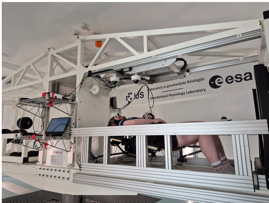
Figure 1: Conducting measurements in the human centrifuge in Planica. Slika 1: Izvajanje meritev v človeški centrifugi v Planici.
